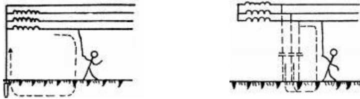
图 2-1 中性点接地系统的单线触电 图 2-2 中性点不接地系统的单线触电
